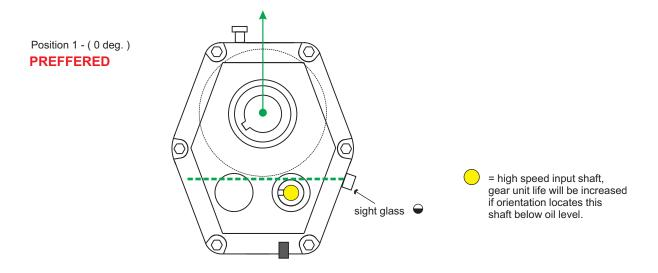
THE SIGHT GLASS CAN ONLY BE USED AS AN OIL LEVEL INDICATOR IN POSITIONIS 1,2,3 or 4
